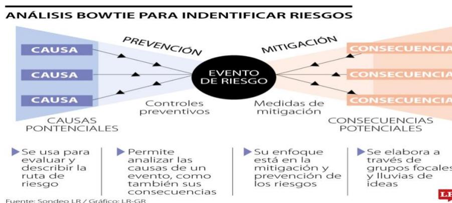
Figura 2. Representación esquemática de la Herramienta Bowtie (corbatín) para el Análisis de Riesgos
